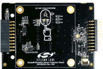
Rys. 2. Układ rozszerzeń dla zestawów startowych serii EFM32
